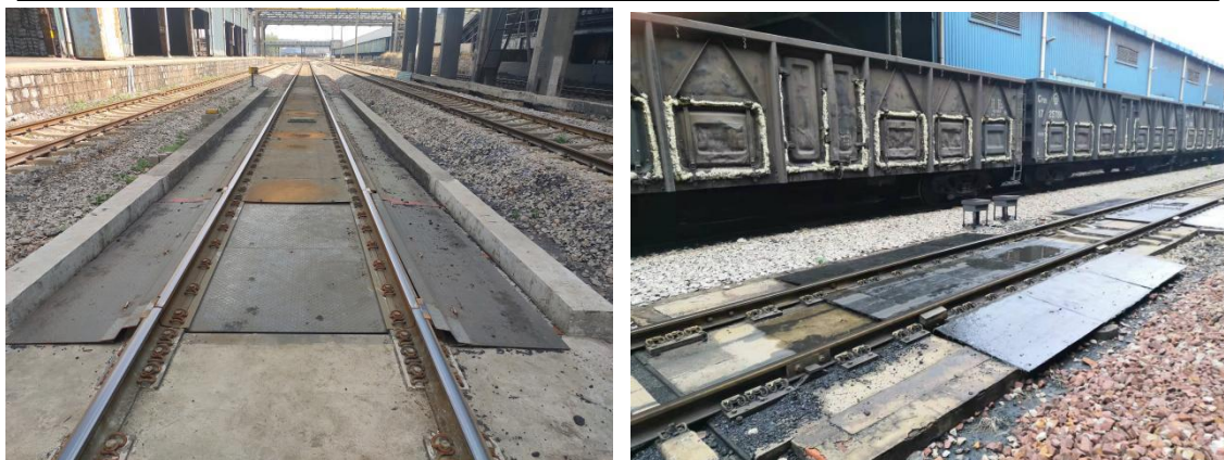
图 2-4 轨道衡（左图静态，右图动态）
